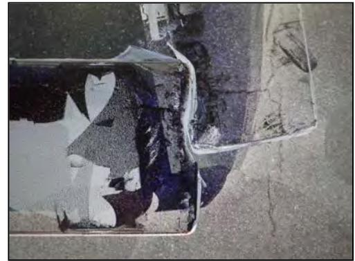
(車両の破損個所の突合せ)
