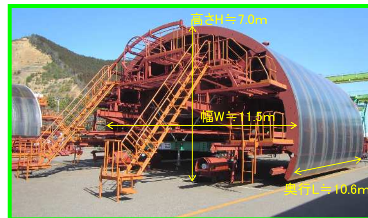
トンネル鋼製型枠 (セントル)
