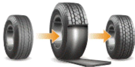
一次寿命が終了したタイヤのトレッドゴム（路面と接する部分のゴム）の表面を決められた寸度に削り、その上に新しいゴムを貼付け、加硫※し再利用（リユース）するものです。台タイヤを再利用できるので省資源に貢献します。
