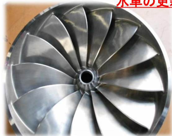
流れ解析による水車形状の最適化
