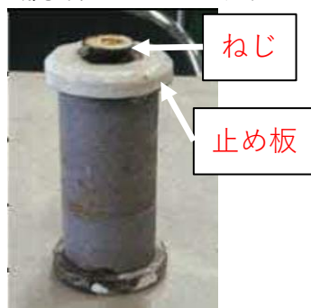
<脱落ボルト写真>
