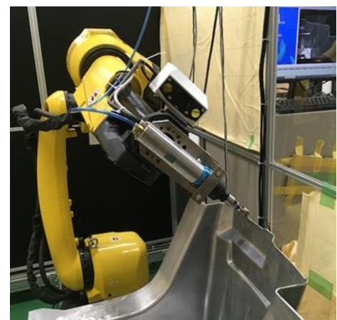
ロボットアームによるバリ取りの様子
