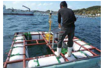
観測浮位の設置
