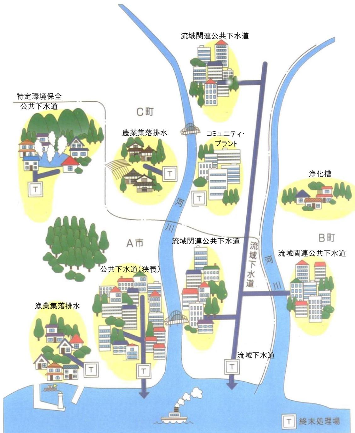
図 1-2 主な汚水処理施設の概念図
