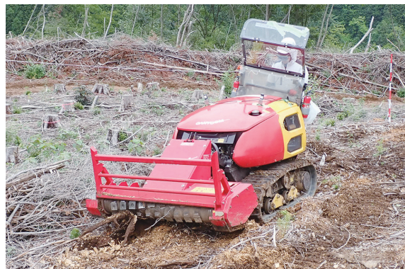
▲1台で多工程を処理する多目的造林機械
