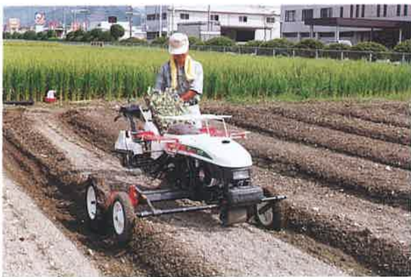
全自動移植機によるキャベツのセル成型苗の移植
