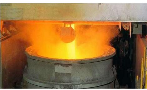
電気炉プラント設備(出鋼)
