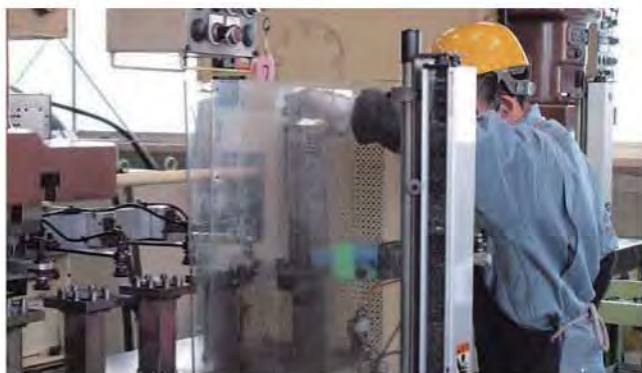
プレス機械に手が入る事故を防ぐため、アクリル板で囲んでセンサーを取り付けている
