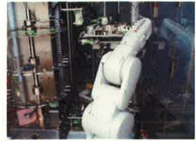
ロボット自動検査装置
