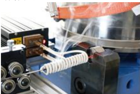
半導体検査用機器に用いる金属(イリジウム)の伸線状況
