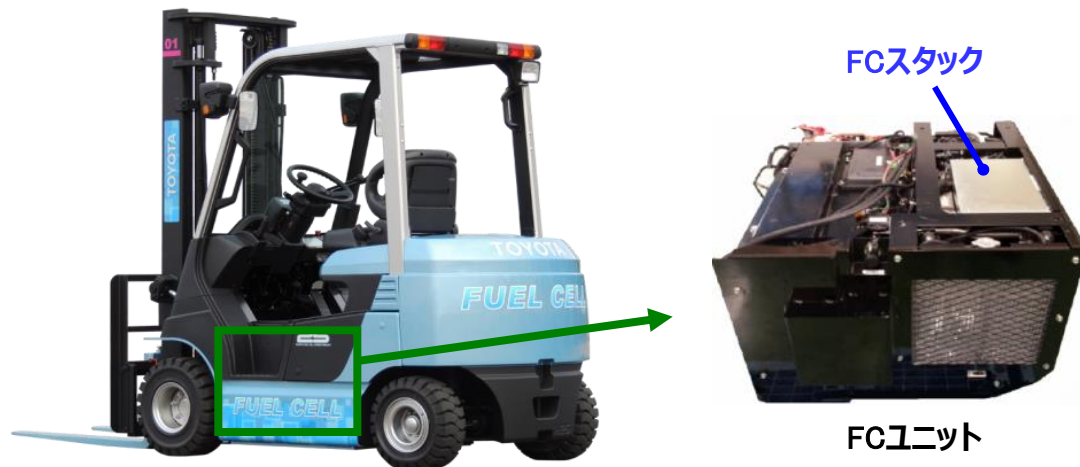
(ベース車両：積載荷重2.5t電動フォークリフト)
