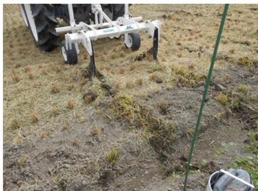
第8図 補助孔再生作業（チゼルプラウ）
