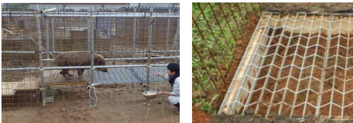
図2 シカ用グレーチングのイノシシ適用試験 左：飼育場、右：屋外（ダイクレ製シカ用グレーチングの網目：縦10cm×横6cm）
