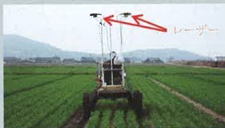
レーザー式生育センサによる小麦「せときらら」の生育診断
