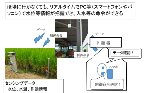
図1 自動給水システム
