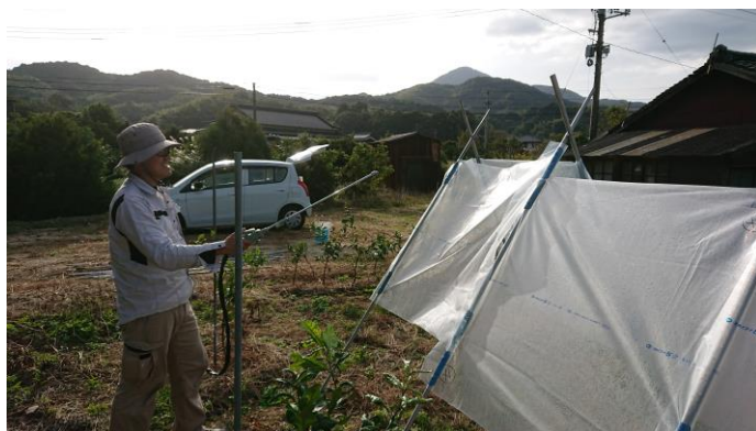
図3 遮光塗布剤の予備試験の実施
