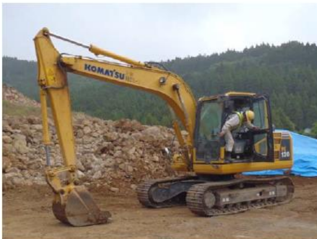
掘削などで使われる油圧ショベル
