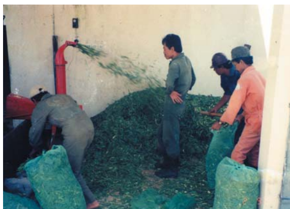
エンジン付き小型カッタによる原料 （エレファントグラス）の細切
