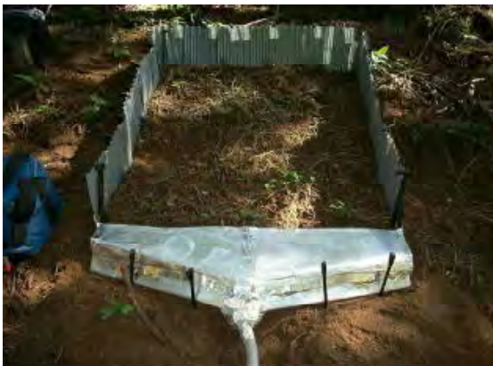
シュート設置状況
