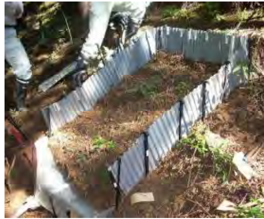
集水枠の設置状況
