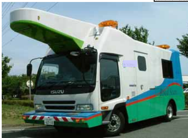
路面性状測定車の例
