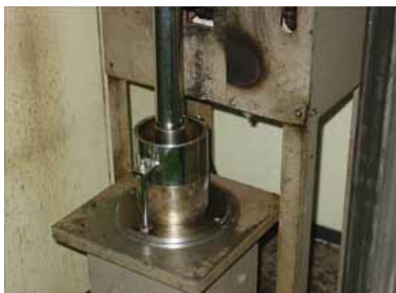
供試体作製（突固め状況）
