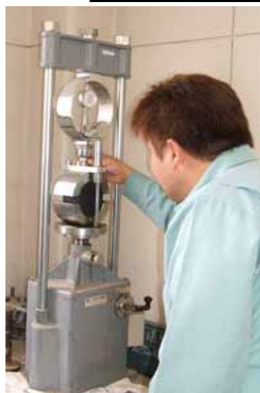
マーシャル安定度試験載荷装置
