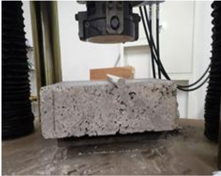
バイブレーター挿入箇所 (写真手前底面)
