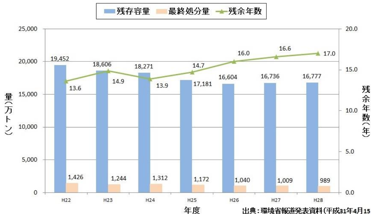
図-1 全国の産業廃棄物最終処分場の残存容量等 (H29.4.1現在)
