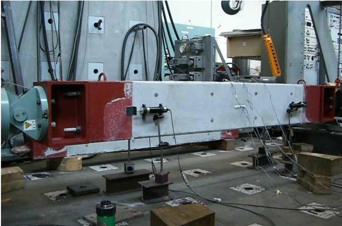
写真1 ひび割れ分散性能実験(直接引張試験)
