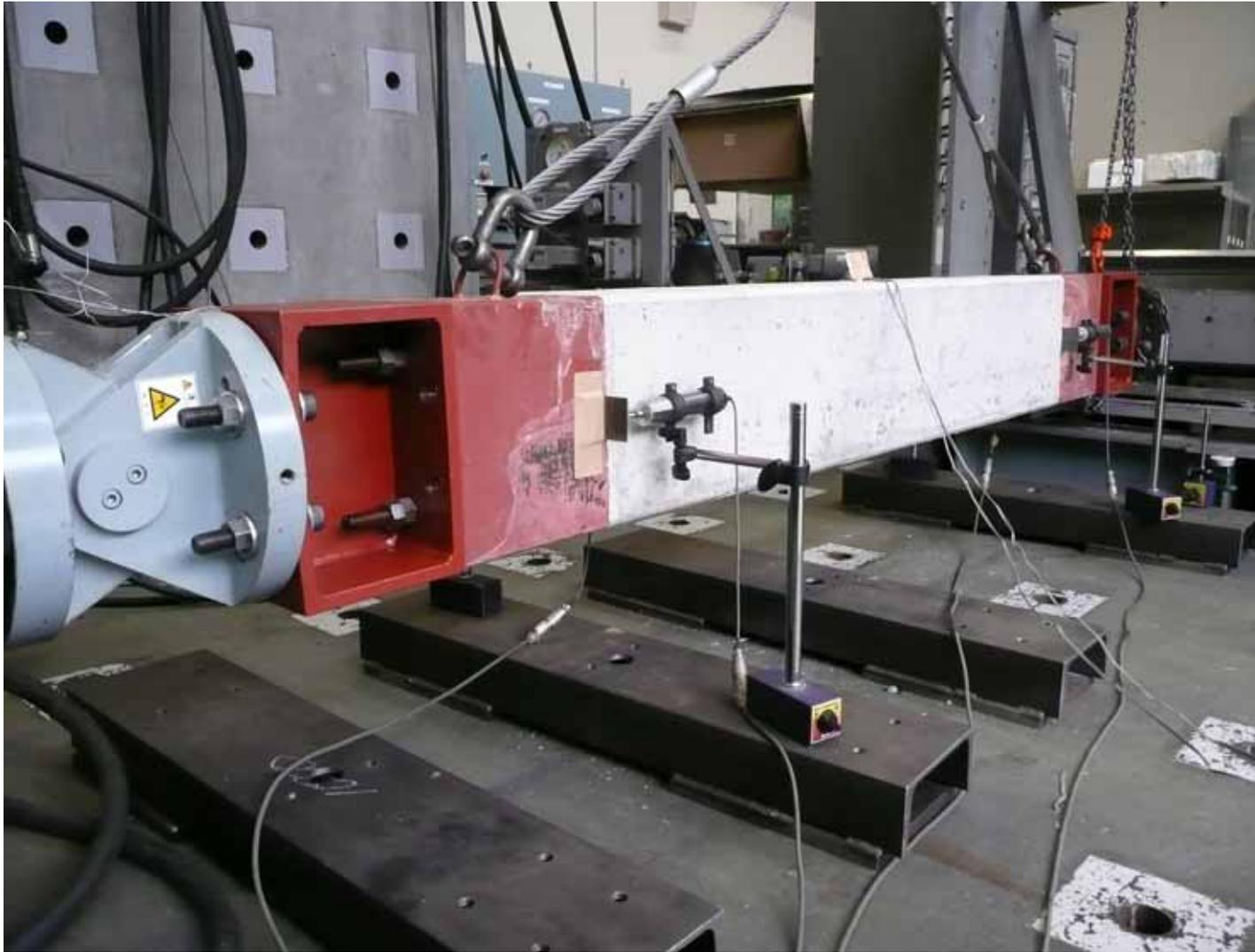
写真2 直接引張試験
