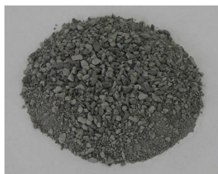
新日鐵住金ステンレス(株)光製造所で 製造されたステンレススラグ (スラグ粒径 5~0mm)
