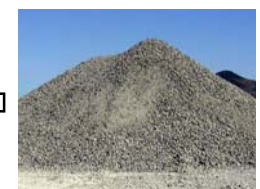
ステンレス電気炉スラグ (一次破碎後の原鉱：60-0mm) 電気炉で副生した溶融状態のスラグ を分別し、凝固・冷却後に一次破碎 したものの。
