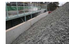
路盤材用スラグ製品 (MS-25) 一次破碎後のスラグを篩い処理し、25mm アンダーに粒度調整した後、蒸気による 促進エージングを施したものの。 (左側が蒸気エージング処理設備)
