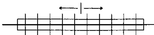
図 2-1 ボルト締付け順序
