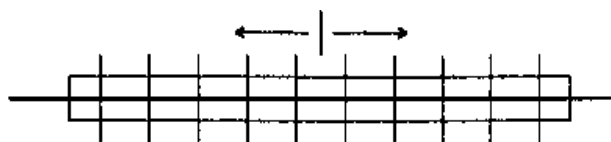
図 2-1 ボルト締付け順序
