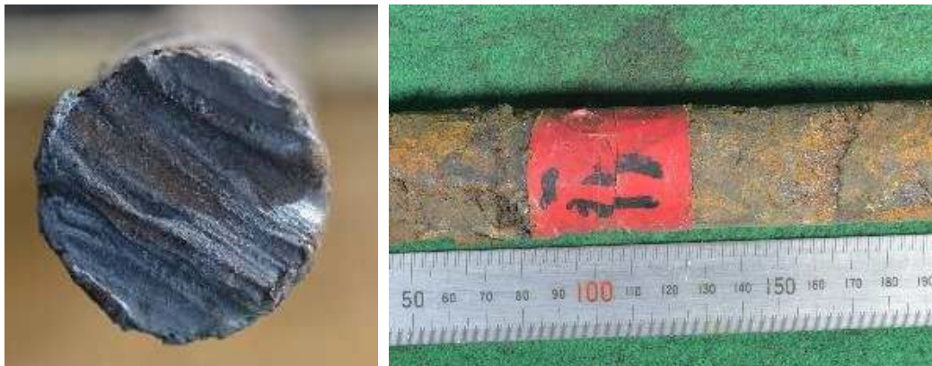
(a)切断面（ガス溶断）
