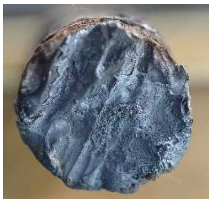
(a)切断面（ガス溶断）
