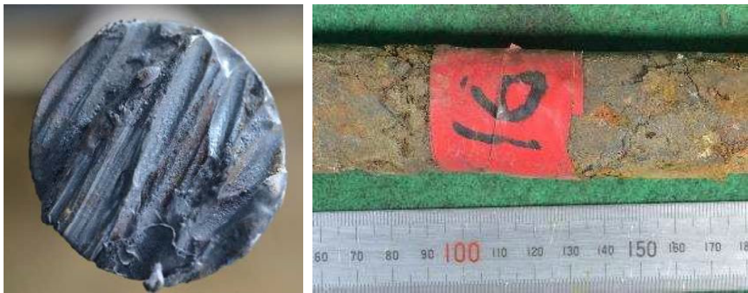
(a)切断面（ガス溶断）
