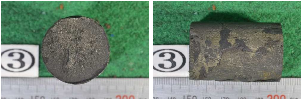
(a)破断面 (b)側面 写真-11 サンプル No.3 の破断面近傍の外観写真（錆除去後）
