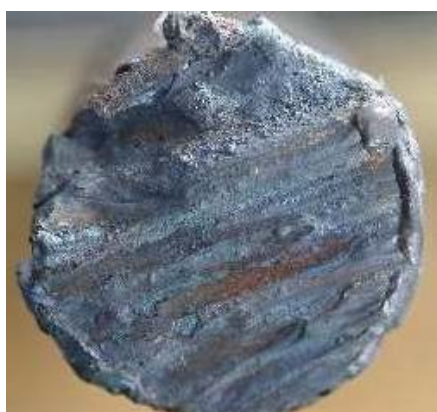
(a)切断面（ガス溶断）
