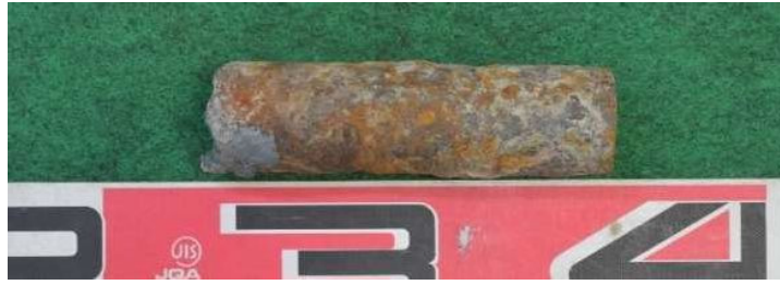
写真-41 サンプル No.12 (箱桁側) の全長の外観写真
