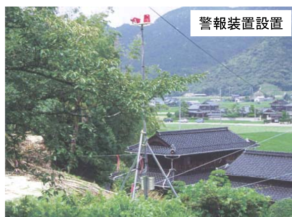
写真-3 土石流センサーおよび警報装置設置状況(石原川)
