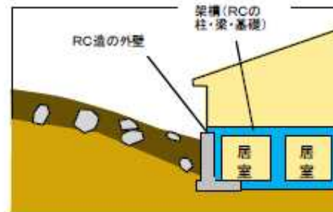
土砂災害に対する構造耐力上の安全性を有しているもの(例)
