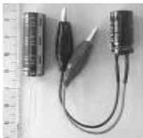
小学校の実験で使われるコンデンサーは「電気二重層コンデンサー」といわれる日本で近年開発された種類であり、コンデンサーとしては驚異的な電気量を蓄えられるため、スーパーキャパシターとも呼ばれている。充電にかわるものとしても開発が続けられている。コンデンサーは、充電時に調整する項目が少なく、また再三の充放電にも強いので、ハイブリッドカーなどに応用可能と期待されている。
