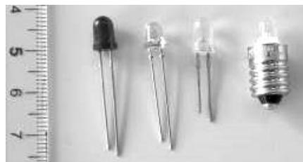
発光ダイオードは，一定の方向にしか電流を通さない性質がある。何も加工をしていない発光ダイオードの場合，長い方の電極が+側，短い方が-側であり，この電流の向きを順方向という。
