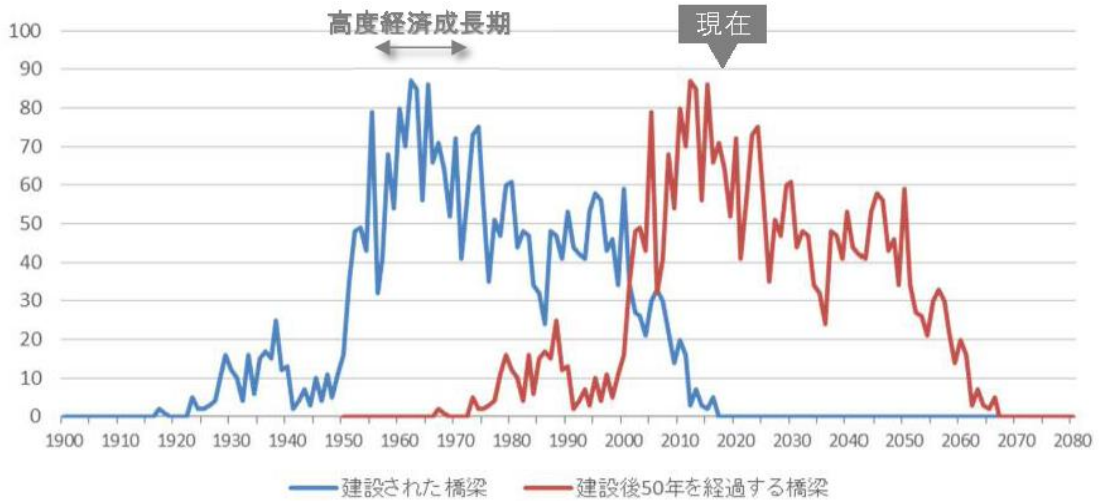
図 1-1 山口県における橋梁の整備状況の推移 (平成 30 年 3 月現在)
