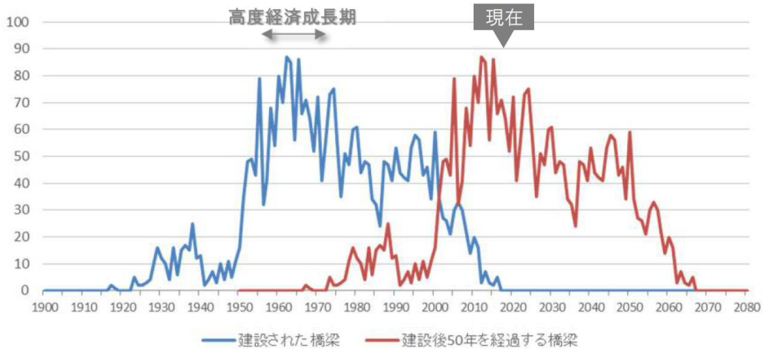
山口県における橋梁の整備状況の推移 (2018年3月現在)
