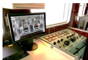
遠隔操作ウインチ実証 (漁労作業の省力化)
