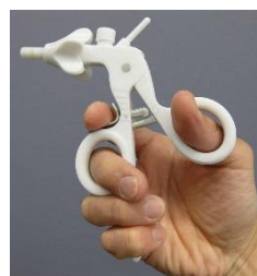
3Dプリンター（樹脂積層式造形機）で製作した試作モデル
